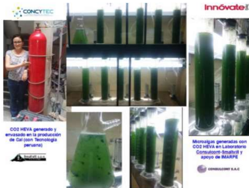
Cultivos de Microalgas en el Laboratorio de SMALLVILL utilizando el CO2 obtenido en el proceso especial de Calcinación y producción de Cal.
