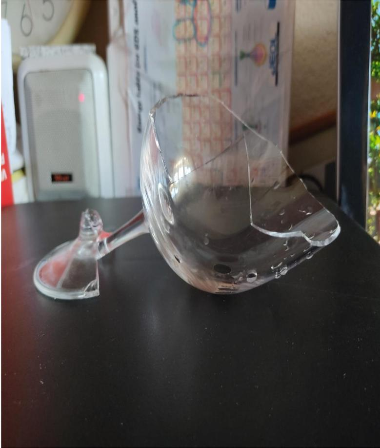
AUNQUE SU RESISTENCIA MECANICA debería ser teóricamente mucho mayor...según GRIFFITH entre 1920-24 postuló la existencia de “microgrietas” para explicar este fenómeno
