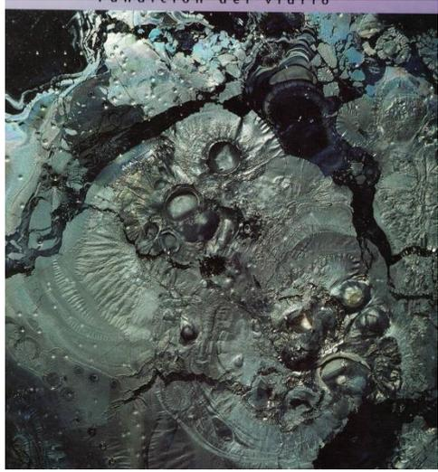
FONDO DE LA SOLERA DE UN HORNO BALSA después de su apagado o parada
