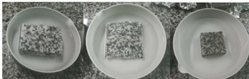
Figura 5. Experimento de confirmación con tres losas de granito completamente sumergidas en disoluciones de ácido oxálico 20 mM (las manchas de hierro no se pueden ver ya que están hacia abajo): Granito 6 (derecha), Granito 7 (izquierda) y Granito 8 (centro).
