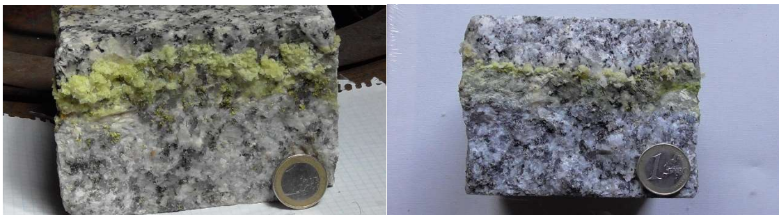
Figura 3. Eflorescencia en la muestra de losa de Granito 2 a 7 días (izquierda) y en la muestra de losa de Granito 5 a 30 días (derecha).
