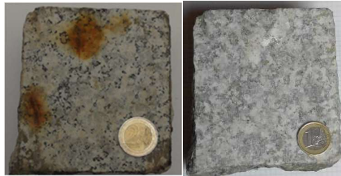
Figura 1. Muestra de losa de Granito 2, al comienzo del experimento (izquierda), y al final del experimento a los 7 días (derecha).
