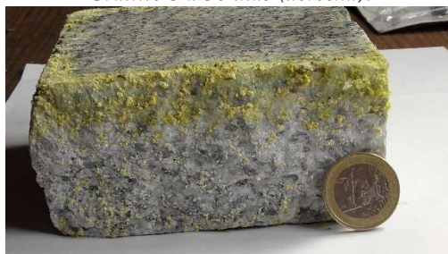
Figura 4. Eflorescencia en la muestra de losa de Granito 4 a 60 días.
