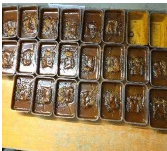
Figura 3. Evolución del experimento. Se puede observar cómo cambia el AMD con el tiempo. Las probetas 1 y 2 ya se habían retirado.
