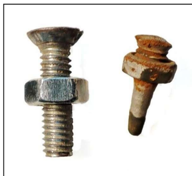
Figura 9. Biocorrosión en condiciones similares a las del experimento con probetas de acero
